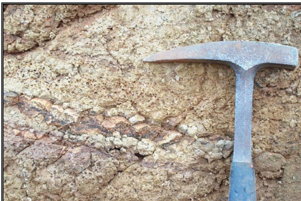
Foto 3.3.3a - Detalhe da geometria do depósito piroclástico (ou riodacitos) além da presença de níveis de vesículas em adiantado processo de intemperismo.
