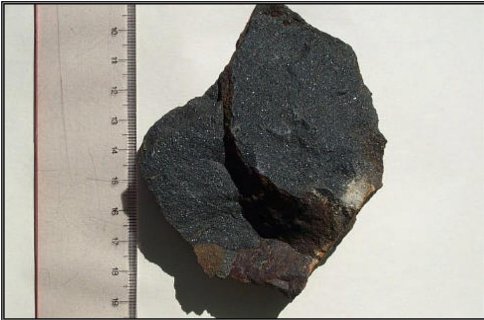
Foto 3.3.4 - Amostra com destaque para textura fina constituída de cristais de plagioclásio ripiformes (pontos brilhantes) e cor preta intensa. Retirada na calha do Rio Turvo.
