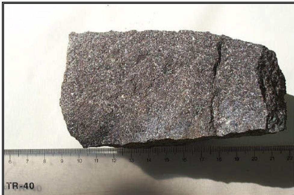
Foto 3.3.7 - Amostra com coloração cinza-avermelhada decorrente dos processos de alteração no plagioclásio. Coletada na região de Guarani das Missões.
