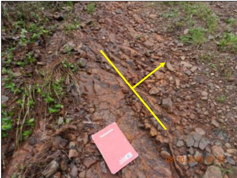
Foto 12: Afloramento com linhas amarelas demonstrando sentido e mergulho das disjunções
